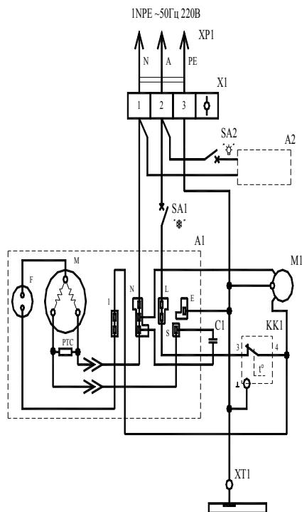
Для проверки компрессора можно использовать выводы I и N (два ряда слева).
